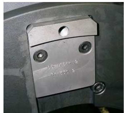
Zentrierung am Flansch der Pumpe über Wechselemente mit Gewinde zur Pumpenbefestigung und Drehmomentaufnahme
