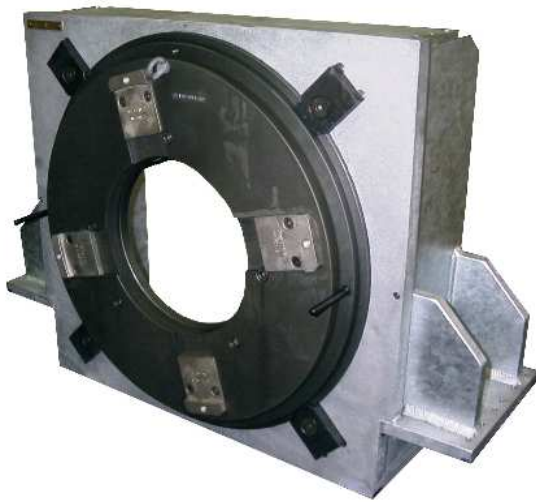
Vorderansicht mit dreh- und wechselbarer Prüflingsaufnahme
