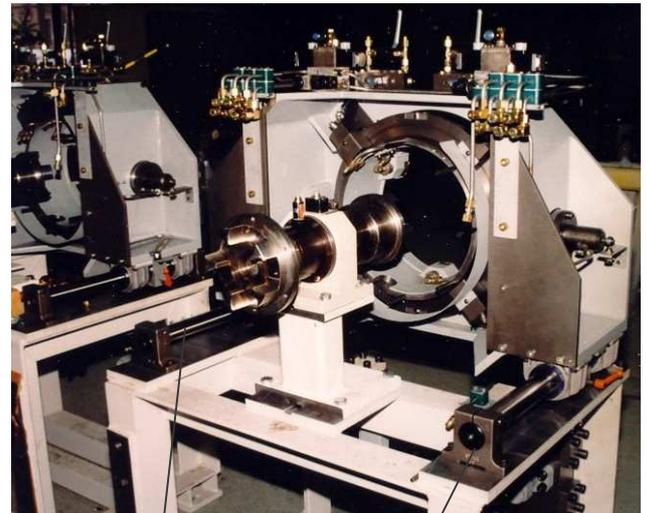
Linearführungen zur Kupplungseinführung an der Antriebsseite
