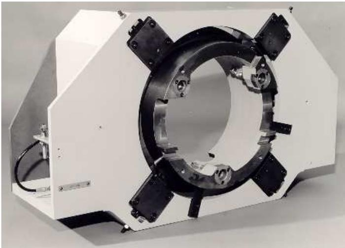
Grundkörper Vorderansicht mit dreh- und arretierbarer Wechselplattenaufnahme und Hydraulikadaption
