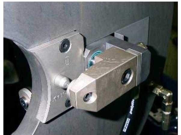
Vorderseite Wechselplatte mit Wechselsegment zur Zentrierung und Drehmomentaufnahme des Prüflings. Hydraulische Positionierung der Klemmung über der Spannstelle und Spannen des Prüflings über Niederzugpratzen
