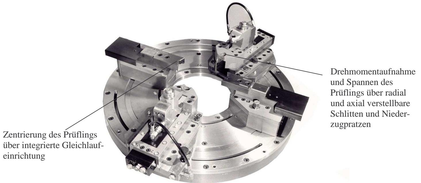
**Alle Fixier- und Spannvorgänge hydraulisch betätigt**
